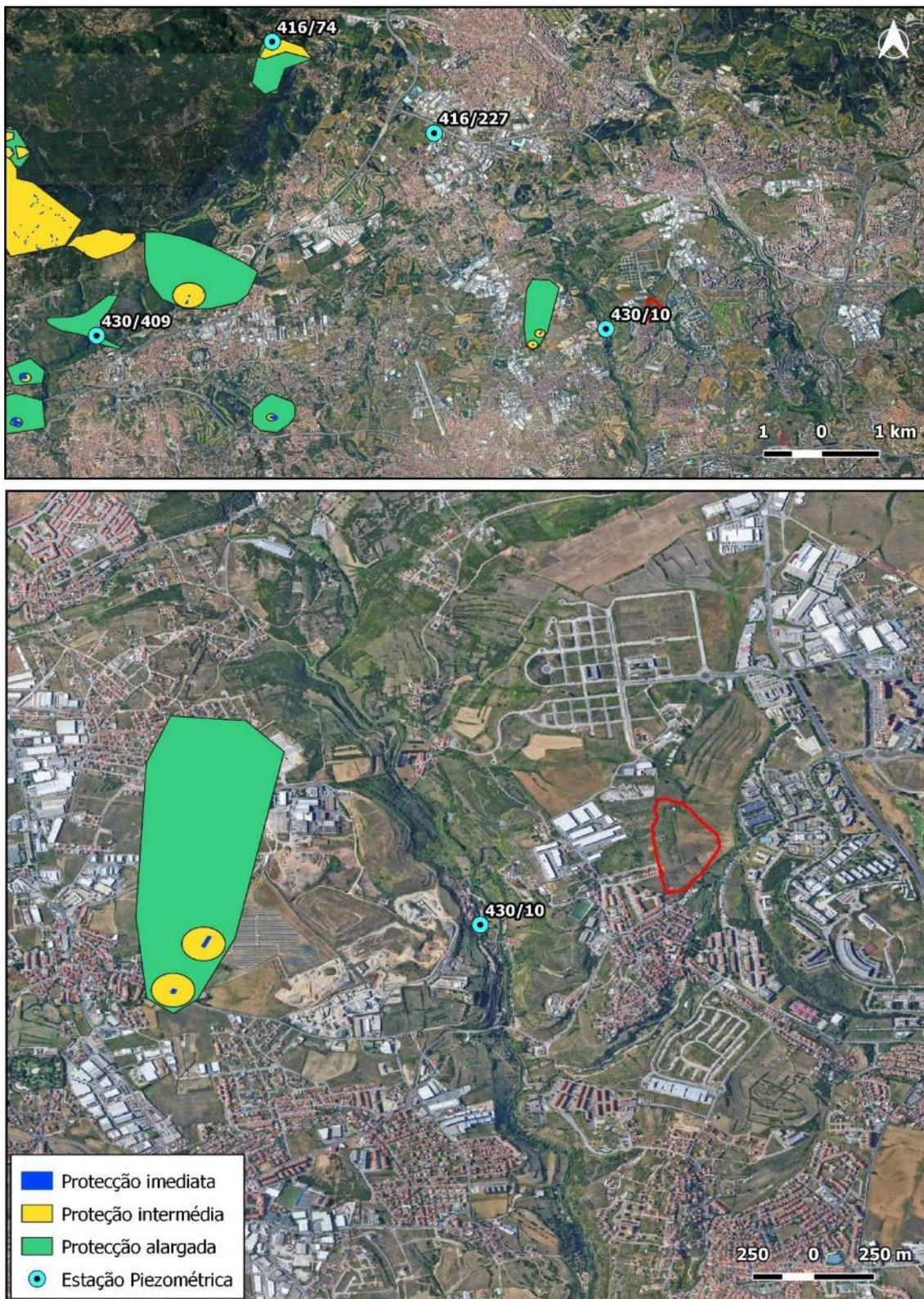
**Figura 43: Localização da estação piezométrica 430/10 e dos furos de captação municipais para abastecimento público e respetivas áreas de proteção**
