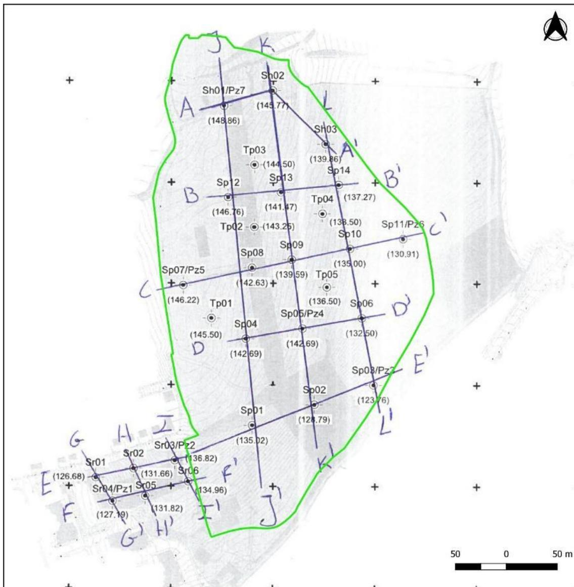
**Figura 9: Localização das sondagens efetuadas no âmbito do Estudo Geológico e Geotécnico**
