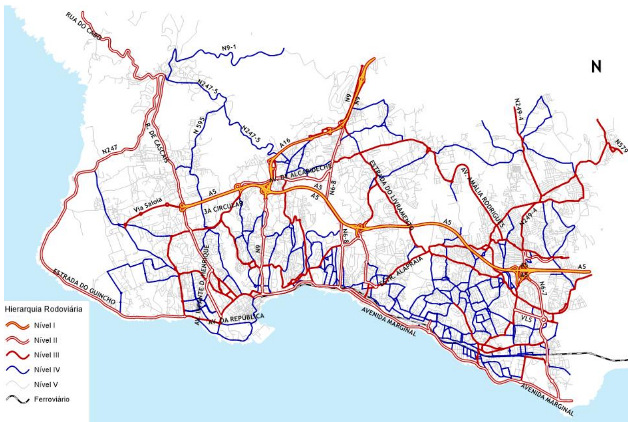
Figura 116 | Classificação da rede rodoviária por nível hierárquico
