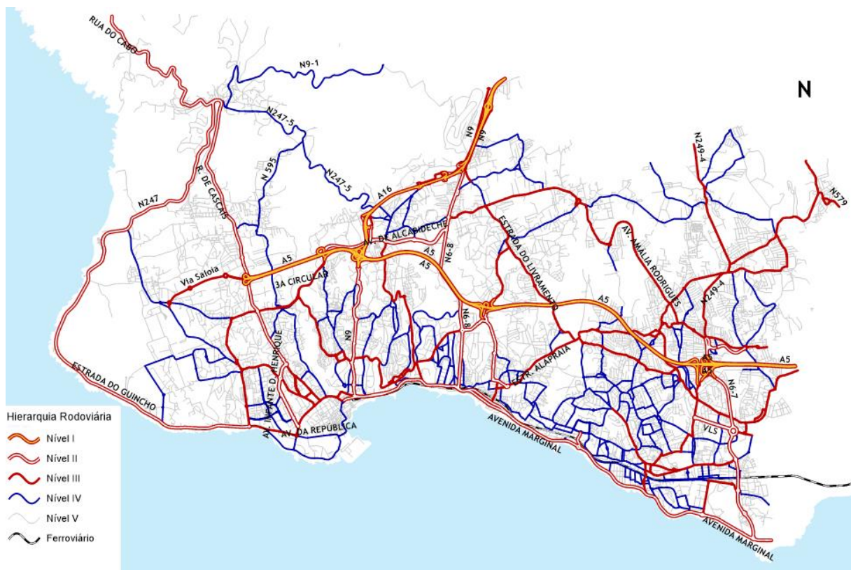
Figura 14 | Classificação da rede rodoviária por nível hierárquico
