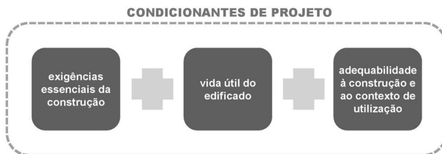
Figura 16. Condicionantes de projeto das soluções construtivas
