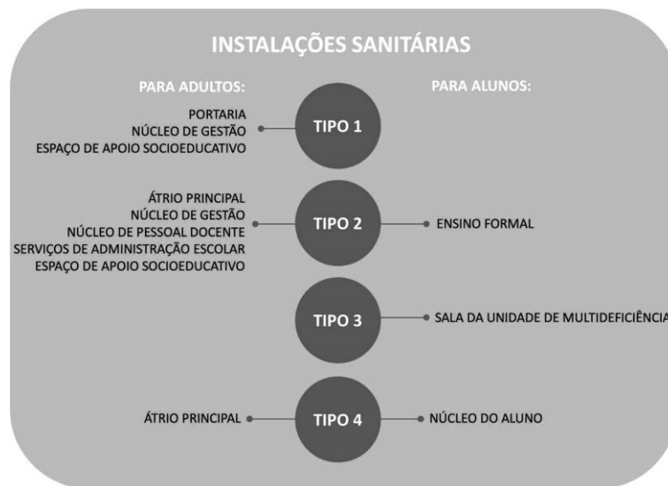
fig. 6: esquema de distribuição de TIPOS DE INSTALAÇÃO SANITÁRIA por alunos e adultos e por espaços funcionais
