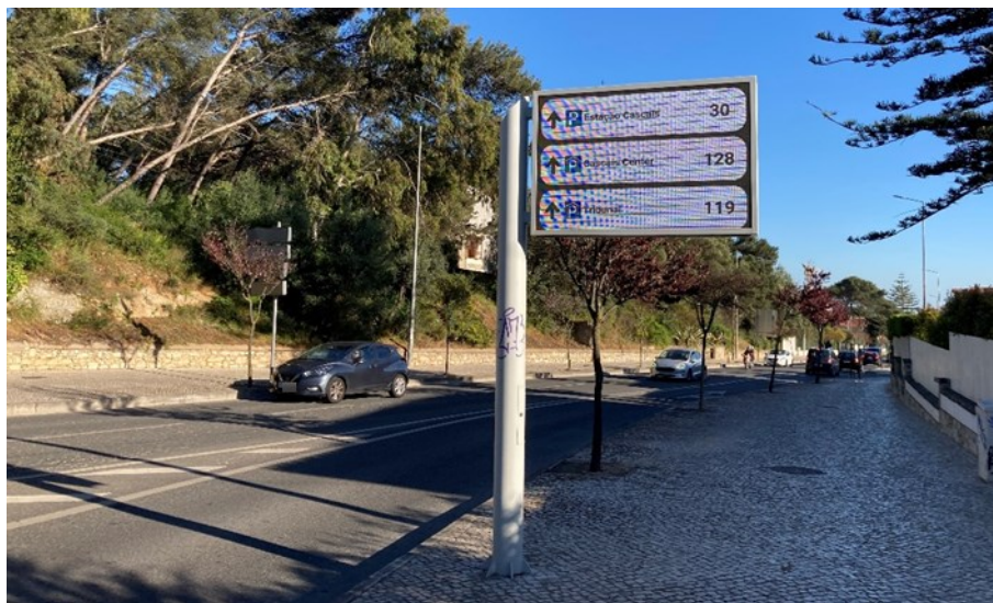
Figura 96 | Painel de mensagem variável na Avenida de Sintra com disponibilidade de estacionamento na Baixa de Cascais
