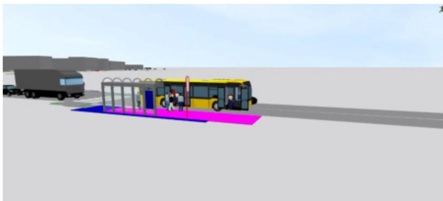
Figura 72 | Modelação do transporte coletivo rodoviário no modelo de micro-simulação
